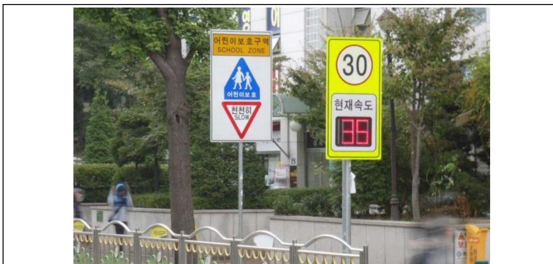
➤ 車速偵測警示牌面顯示超速車輛車速<sup>3</sup>
